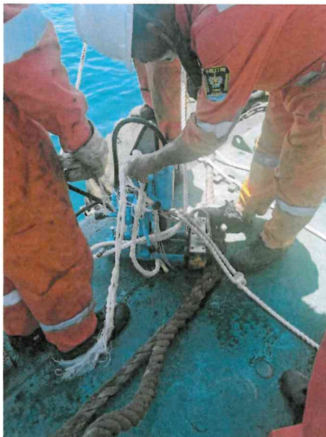
图 12. 调试检查水下开孔机
